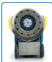
Groupe suceur pivotant pour une aspiration parfaite dans les virages et le long des murs.
