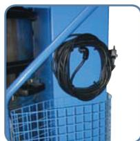
paniers latéraux et système d'enroulement du câble
